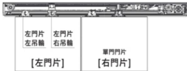
先依據下圖示將皮帶固定架C螺絲孔的上1排及3排與左門片右吊輪鎖緊固定，再將皮帶固定架C與上層皮帶鎖緊固定，以完成皮帶安裝。
